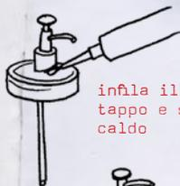
infilare il dispenser nel foro del tappo e sigillarlo con della colla a caldo
